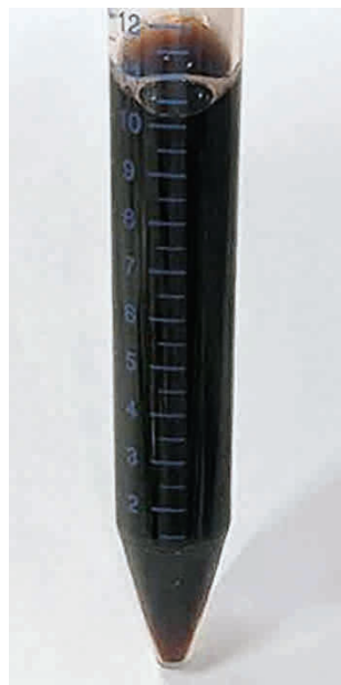
図2 カルノア液を添加して半固定した様子
