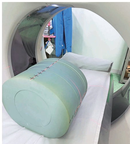
Fig. 2 ファントムの設置
